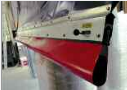
Beim Anfahren des Bodenabschlussschwertes öffnet sich automatisch der Rückhaltemechanismus.
