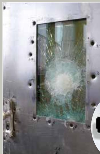
Geprüft und zertifiziert - gemäß Widerstandsklasse DIN EN 1522/1523-FB 4 NS. Im Rahmen der Prüfung werden das Türblatt und die Verglasung entsprechend der Beschussbedingungen der Klasse FB 4 beschossen.
